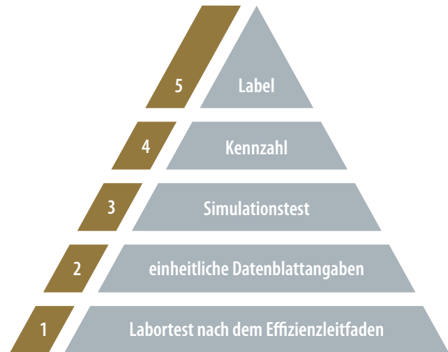
Grafik 1: Logik des Speichervergleichs. Der Effizienzleitfaden erlaubt es, die Geräte im Labor einheitlich zu vermessen und daraus Datenblattangaben abzuleiten. Darauf aufbauend können die Experten das Speicherverhalten simulieren und Kennzahlen wie den System-Performance-Index errechnen. Im Prinzip könnte am Ende ein Effizienzlabel stehen.
